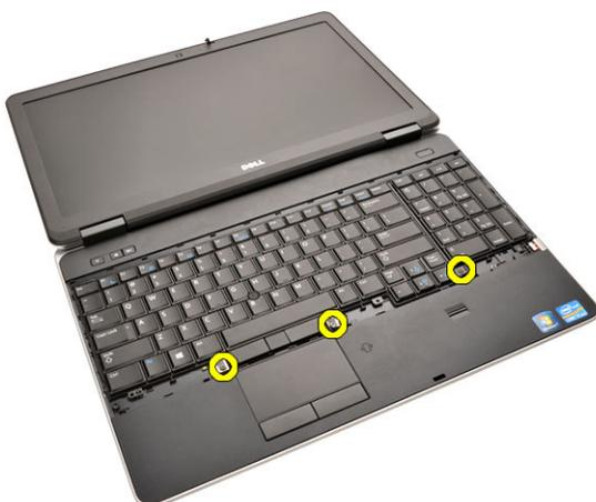
7. Vire o teclado e desconecte o cabo do teclado da placa de sistema.
