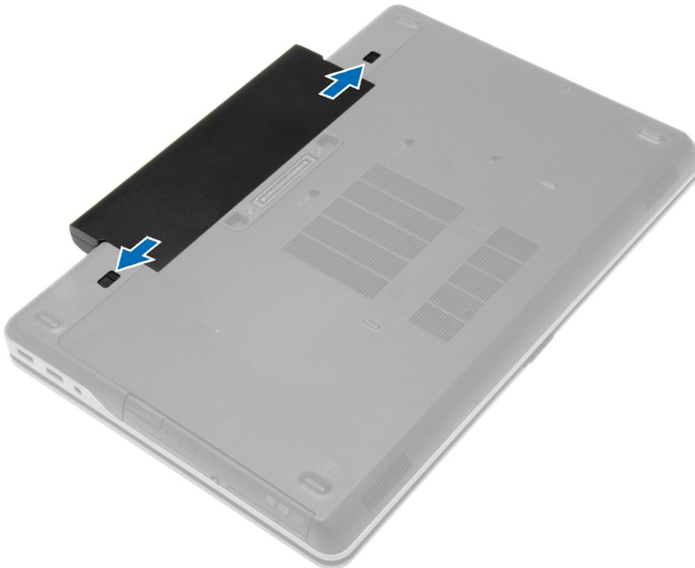
3. Desencaixe a bateria para removê-la do computador.
