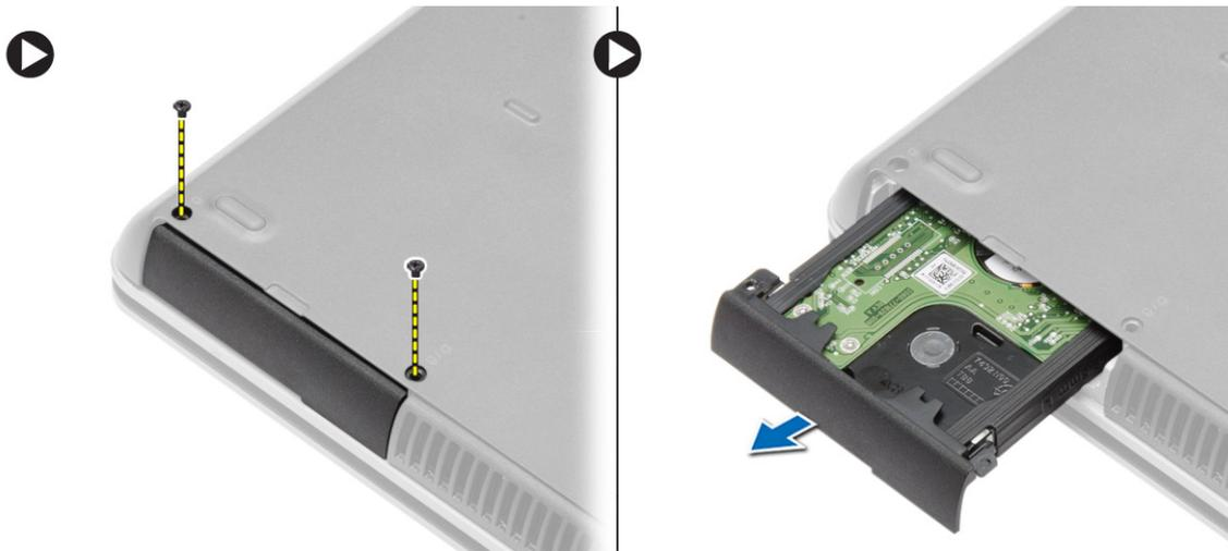
4. Remova o parafuso que prende o caddy do disco rígido ao disco rígido. Remova o caddy da unidade de disco rígido do disco rígido.
