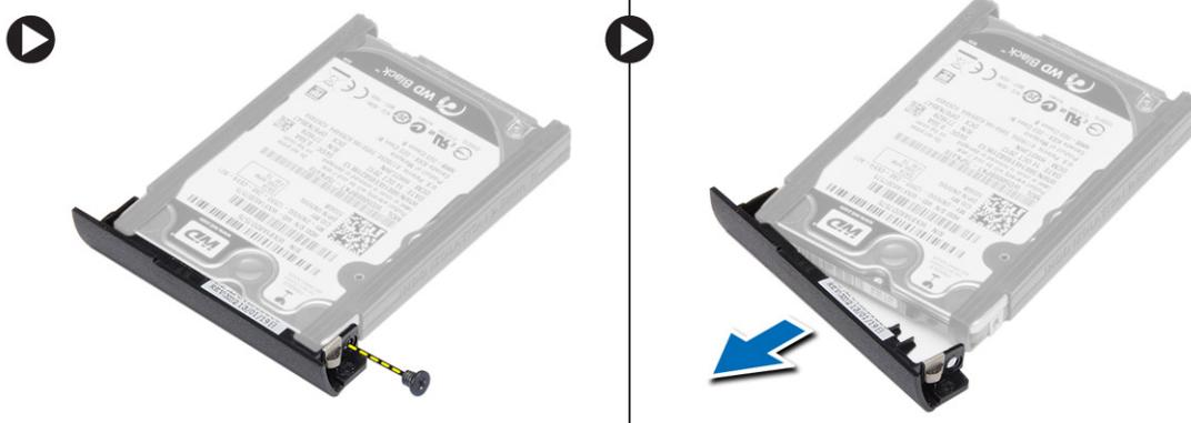
5. Flexione o isolamento de unidade de disco rígido. Retire o isolamento de unidade de disco rígido do disco rígido.
