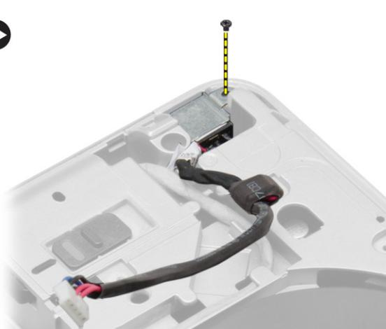
4. Levante o suporte do conector de alimentação do computador. Levante o conector de alimentação do computador.
